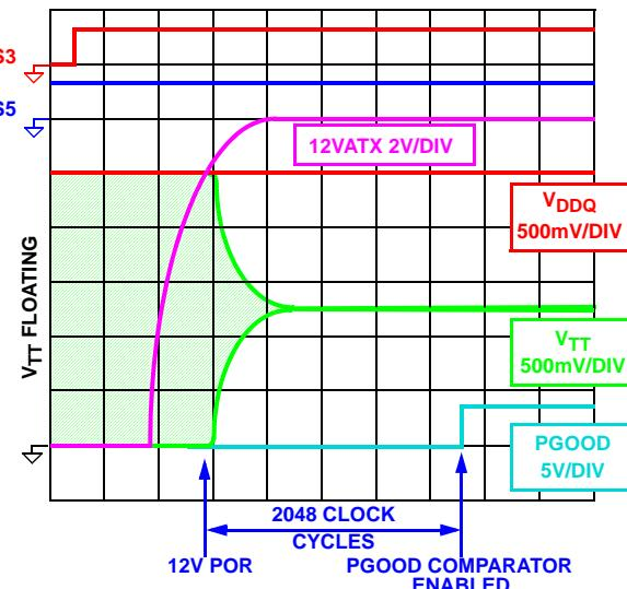
FIGURE 2. TYPICAL S3 TO S0 STATE TRANSITION
