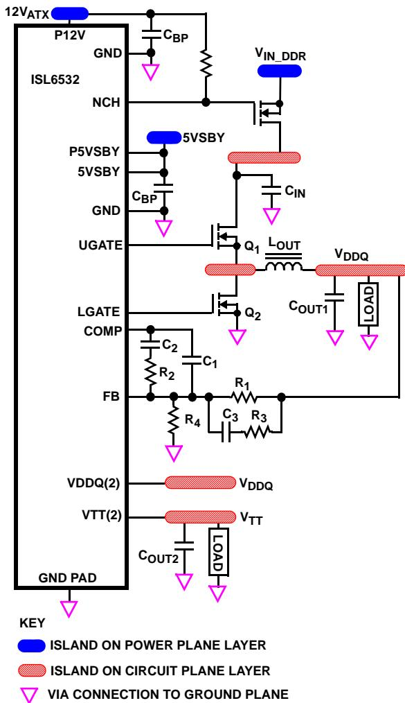
FIGURE 4. PRINTED CIRCUIT BOARD POWER PLANES AND ISLANDS
