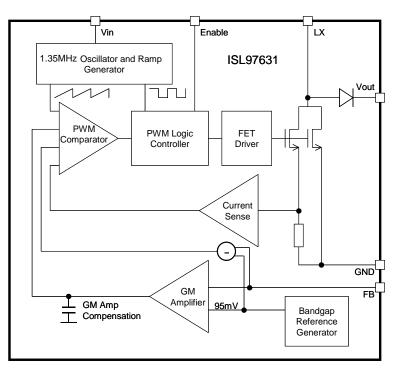
FIGURE 7. ISL97631 BLOCK DIAGRAM
